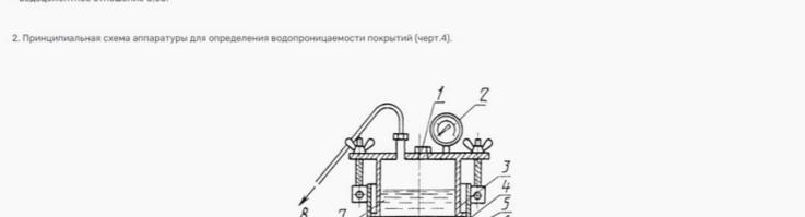
1 - герметизирующая паста; 2 - испытываемое покрытие; 3 - обойка; 4 - испарительный стакан с водой; 5 - резиновый коврик; 6 - резиновое кольцо; 7 - образцы
